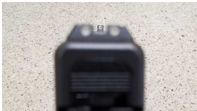
Het enige echt juiste richtbeeld bij mechanische richtmiddelen; keep wazig, korrel scherp.
