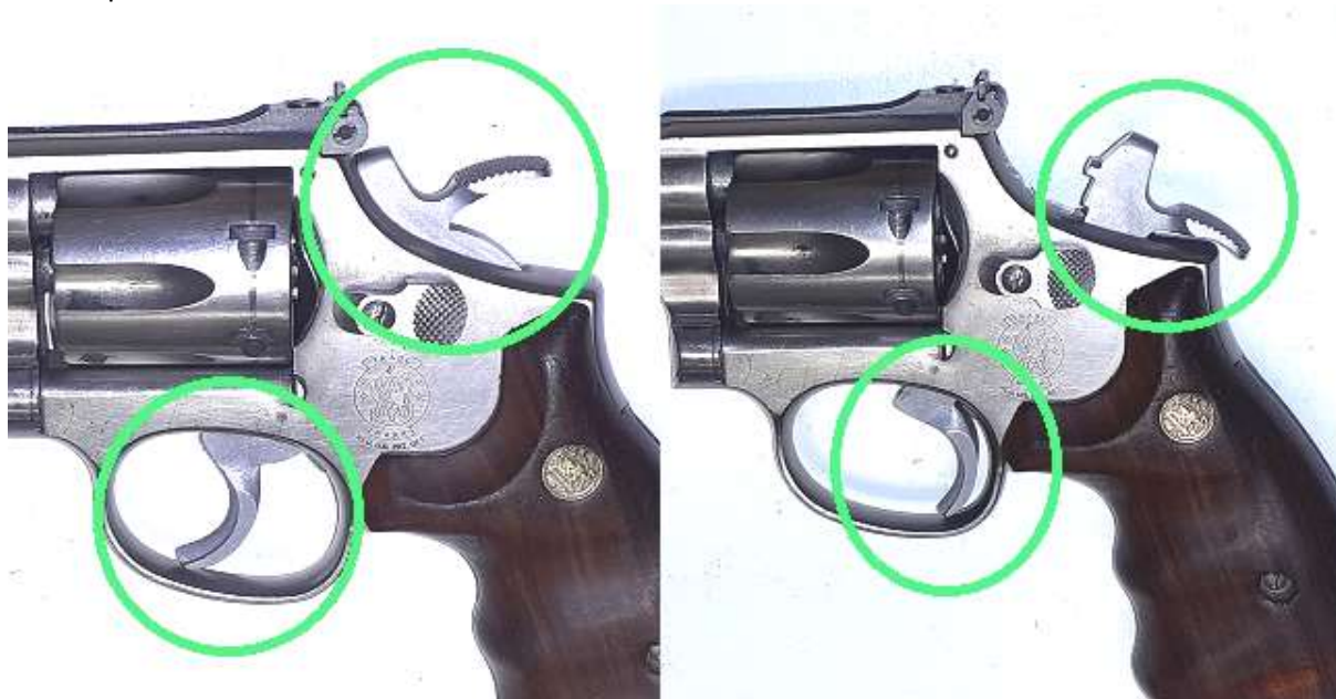
Trekker en haan allebei ontspannen, trekkerweg is 2,5cm
